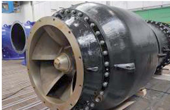
Funkční vzorek čerpadla s potlačenou vstupní recirkulací (vlevo) a odvozené produkční čerpadlo pro čerpací stanice v Egyptě (vpravo)
