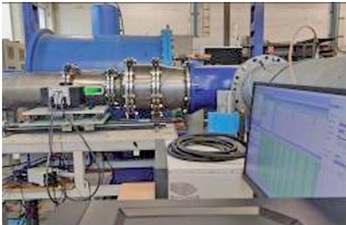
Funkční vzorek čerpadla s potlačenou vstupní recirkulací (vlevo) a odvozené produkční čerpadlo pro čerpací stanice v Egyptě (vpravo)
